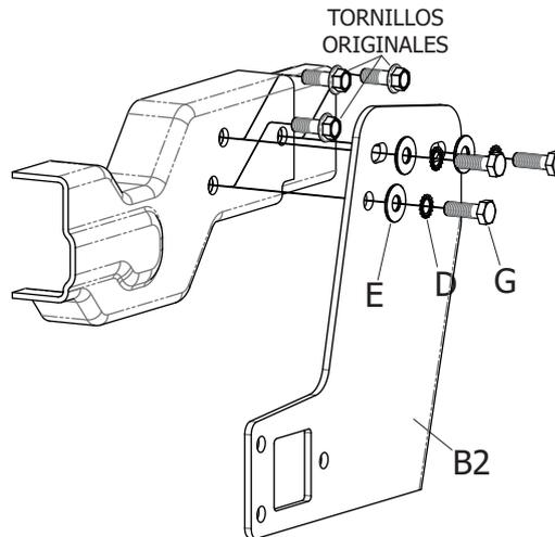
RETIRAR LOS TORNILLOS ORIGINALES QUE SUJETAN EL SOPORTE DEL PARAGOLPES, COLOCAR LAS PLACAS LATERALES (B1 Y B2) Y SUJETAR CON LOS TORNILLOS Y LAS ARANDELAS PROVISTAS (G, D Y E), SIN AJUSTAR TOTALMENTE HASTA COLOCAR EL TRAVESAÑO (A)
